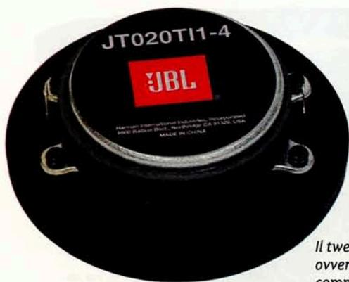
Il tweeter dalla cupola in titanio da 0,75", ovvero circa 20 mm, è dotato di un buon complesso magnetico in ferrite. Notare la piccola camera d'aria ricavata sul polo centrale.
